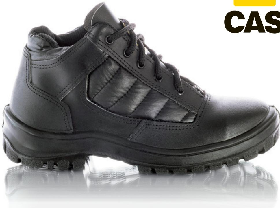
**Planta exterior :** Cuenta con canales longitudinales para favorecer la tracción y el agarre absorbiendo en el ancho las irregularidades del terreno. Los canales transversales permiten el movimiento controlado de la torsión. Cuenta con un dibujo antideslizante y auto-limiante. En la zona de enfranque cuenta con una hendidura que opera como traba escaleras.
